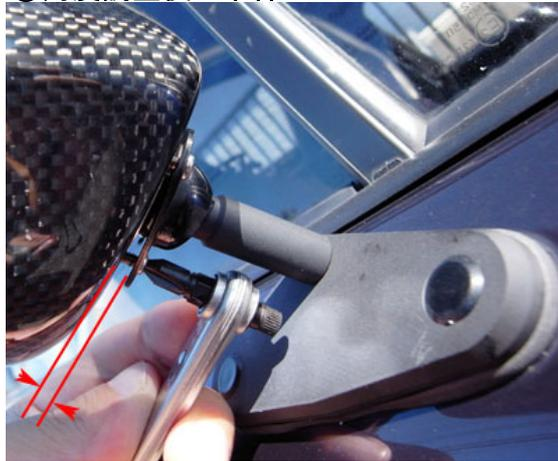
ミラーの角度調整した後にボールジョイントを本締めします。
